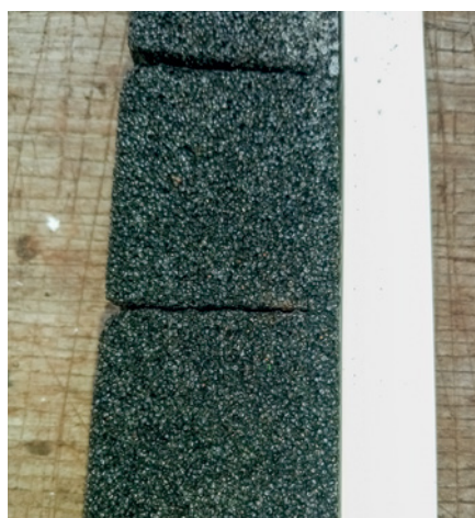
Fig. 8 : vue rapprochée du support de boutures du dispositif du Caté (bande de mousse + cornière PVC).
