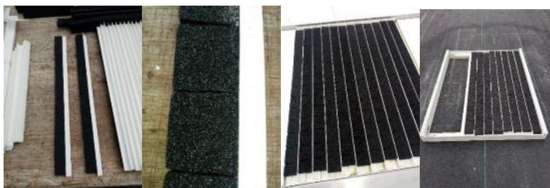
Figure n°16 : procédé n°4 d'insertion des boutures. Fabrication CATE - 2025. A gauche : unité de base. Au centre : détail. Les boutures viendront s'insérer dans les fentes découpées dans la mousse. A droite : chaque module est destiné à être posé à touche-touche sur la table porteuse ou dans un cadre adapté pour un usage comparable à une plaque de bouturage.
