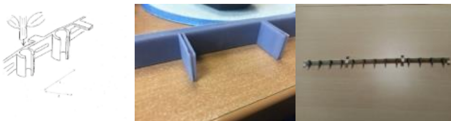
Figure n°14 : Procédés n°3 d'insertion des boutures. Prototypes fabriqués au CATE par impression 3D.
