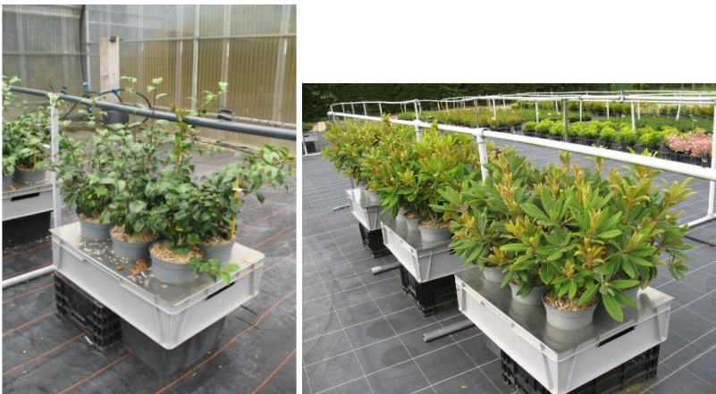
Figure 1 : Lysimètre utilisé pour mesurer le lessivage des nitrates des cultures en conteneur.
