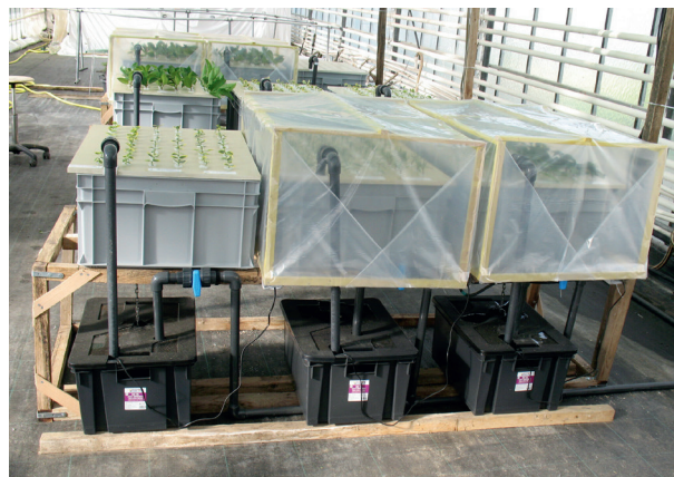
Dispositif expérimental de bouturage en aéroponie.
